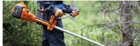
3. **Arrêter** la machine en cas de bourrage ou dysfonctionnement. La tête de coupe, est l'élément le plus dangereux. Dès le moindre doute, une perte d'équilibre, un mouvement inopportun, une résistance, ... il faut lâcher la sécurité pour stopper la machine.
