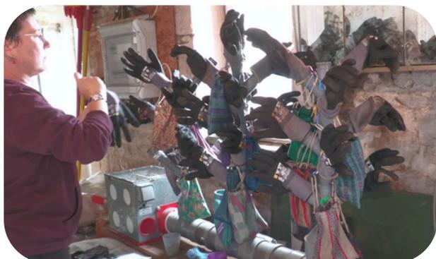
Le séchoir à gants évolutif est un système constitué d'un moteur de ventilation mécanique contrôlée sur lequel est fixée une conduite principale en PVC de laquelle partent une série de ramifications composées de tubes en T et en Y où l'on peut faire sécher les gants des travailleurs (très utile lorsque l'on a des saisonniers en maraîchage par exemple).
