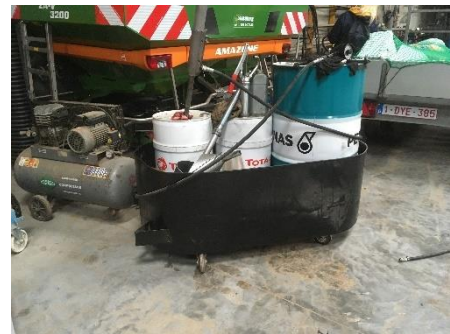
Exemple d'un rouleur de fût avec bac de rétention réalisé par un exploitant agricole
