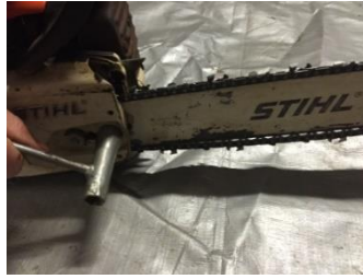
Figure 6 Réglage de tension de chaîne
