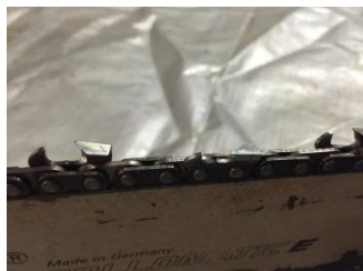
Figure 4 Chaîne correctement montée sur le guide
