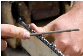
Figure 8 Affutage manuel d'une chaîne
