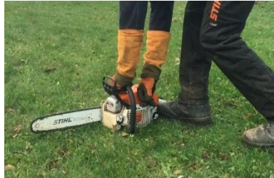
Figure 9 Positionnement pour le démarrage de la tronçonneuse
