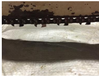
Figure 7 La chaîne est tendue correctement
