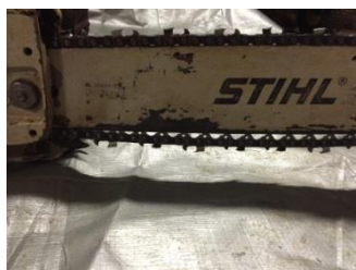
Figure 5 La chaîne n'est pas suffisamment tendue
