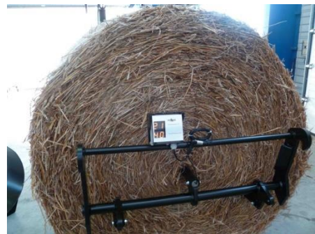
Prise de température et d'humidité avec une sonde (source photo Magsi)
