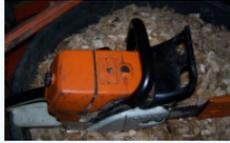
Le frein de chaîne est un dispositif de sécurité important qui permet l'arrêt de la chaîne en une fraction de seconde. Avant de démarrer la tronçonneuse, il faut vérifier que le frein de chaîne est effectivement fonctionnel. Le dispositif peut être déformé et, dès lors, ne plus fonctionner. Un faux-mouvement pourra entraîner une rotation non voulue de la chaîne.
