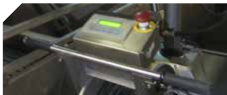
Le robot est équipé d'un joystick et d'un ordinateur de bord permettant de programmer et de lancer le lavage
