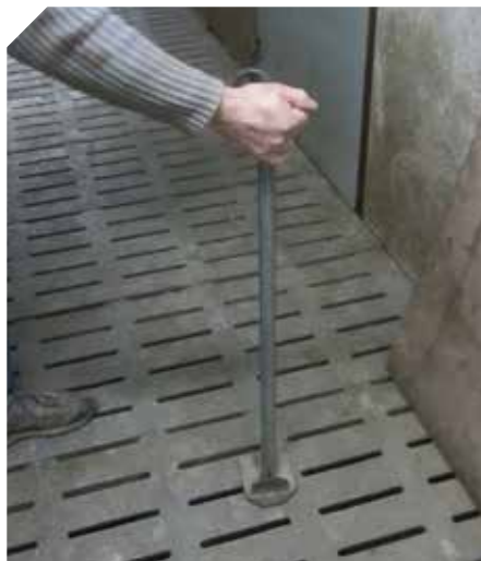
Le dispositif s'insère dans les caillebotis pour bloquer les panneaux
