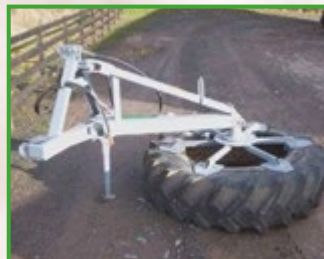
(© HSE) Un « pousseur de silage » monté sur un tracteur facilite le rabattage de la nourriture au plus près de la zone d'alimentation
