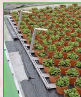
Poignées et manches permettant de soulever plusieurs petits pots simultanément sans devoir se baisser
