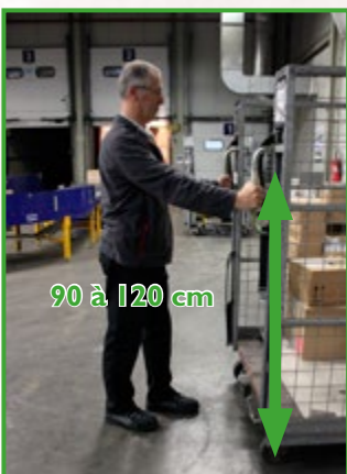
Chariots avec poignées situées à bonne hauteur (entre 90 et 120 cm)
