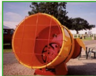
(© HSE) Une désileuse permet de distribuer la nourriture dans les auges sans effort de manutention
