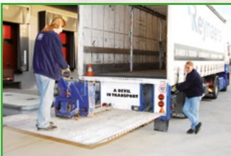
Les hayons mécanisés ainsi que l'emploi de transpalettes électriques sont deux moyens de faciliter le déplacement des charges
