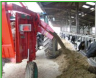
(© HSE) Une désileuse permet de distribuer la nourriture dans les auges sans effort de manutention
