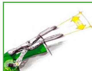
Un guidon de tondeuse réglable en hauteur évite les flexions du tronc vers l'avant et le travail bras tendu
