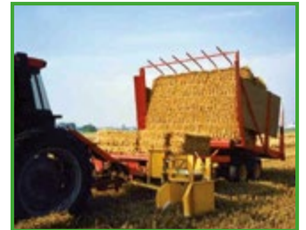
(© HSE) Un accumulateur ou groupeur de balles pour remplacer la manutention manuelle
