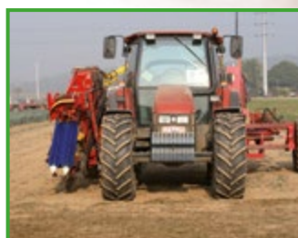
Une machine topiaire permet de réduire la répétition des gestes liés à la taille des buis avec un taille-haie manuel
