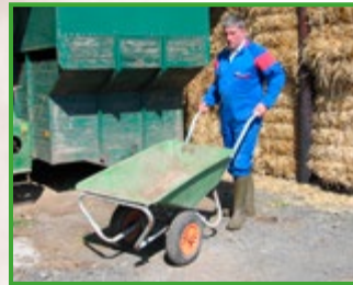
Des grandes roues facilitent le déplacement du chariot sur un terrain irrégulier
