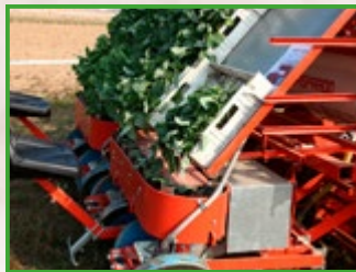
© Pluk-o-trak Munchkof Les machines de récolte des fruits réduisent les distances d'atteinte et de dépose des fruits
