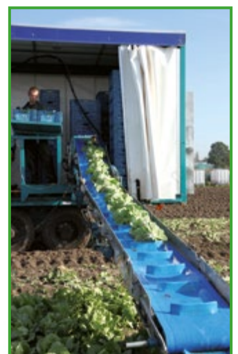
Bandes transporteuses ou rouleaux évitant de nombreux déplacements
