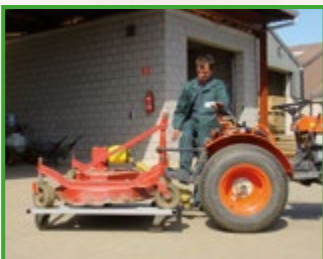
Chariot permettant de faciliter l'accrochage de la tondeuse au tracteur, en la positionnant à bonne hauteur par rapport au système d'arrimage
