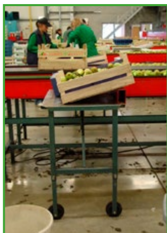
Inclinaison du bac de récolte de poires ou de salades permettant une meilleure vision et une moindre flexion de la nuque
