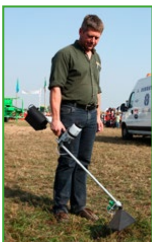
Pulvérisateur avec rallonge évitant de se pencher en avant
