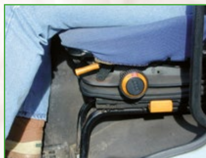
Siège avec suspension mécanique
