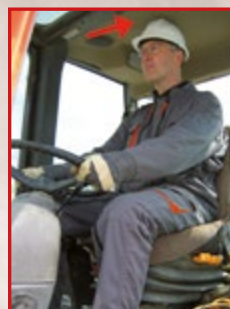
Distance insuffisante entre la tête du travailleur et le plafond de la cabine
