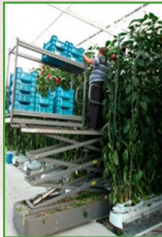
Des grandes roues facilitent le déplacement du chariot sur un terrain irrégulier
