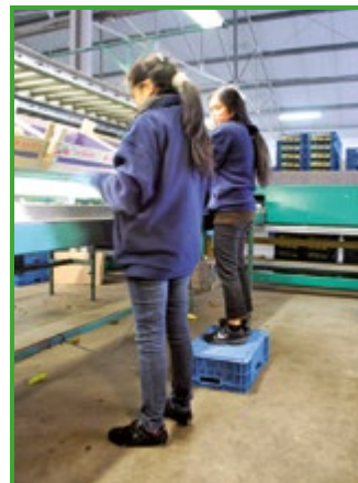
Utilisation de bacs comme rehausse. Un élément plus stable est néanmoins à privilégier
