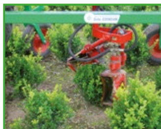
Une machine topiaire permet de réduire la répétition des gestes liés à la taille des buis avec un taille-haie manuel
