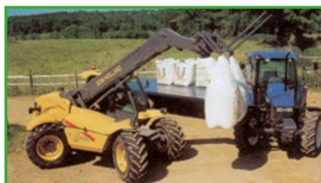
Le regroupement des sacs en un seul contenant de type big bag, déplacé mécaniquement par palan ou avec les fourches du tracteur remplace les nombreux déplacements avec des sacs
