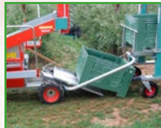
© Pluk-o-trak Munchkof Les machines de récolte des fruits réduisent les distances d'atteinte et de dépose des fruits
