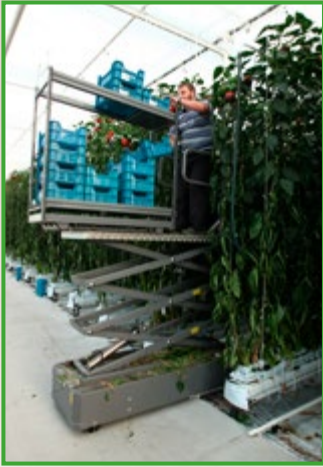
Élévateur permettant la cueillette des poivrons
