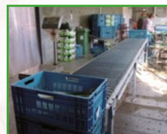
Bandes transporteuses ou rouleaux évitant de nombreux déplacements
