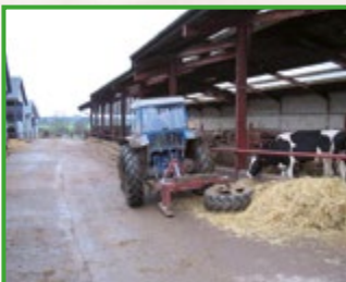
(© HSE) Un « pousseur de silage » monté sur un tracteur facilite le rabattage de la nourriture au plus près de la zone d'alimentation
