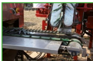
Une arracheuse automatique qui associe récolte et nettoyage automatique permet de réduire la répétition de mouvements à risques pour le dos et les membres supérieurs. Notamment lors de la pose des légumes sur la bande transporteuse
