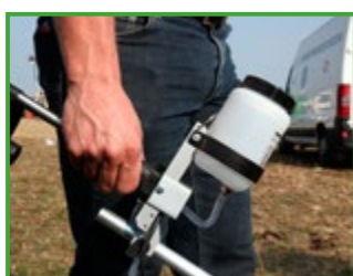
Pulvérisateur avec rallonge évitant de se pencher en avant
