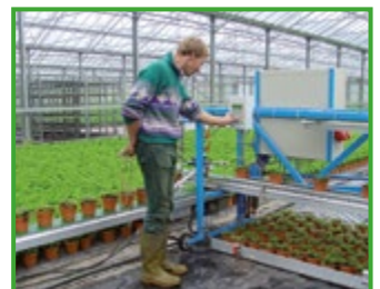
Un robot de plaçage permet d'éviter la répétition de la manutention des pots ©Ezendam
