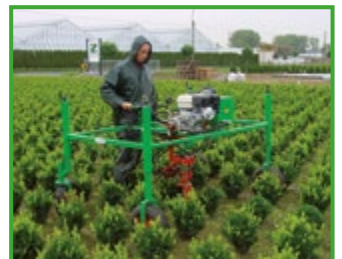
Une machine topiaire permet de réduire la répétition des gestes liés à la taille des buis avec un taille-haie manuel ©Ezendam
