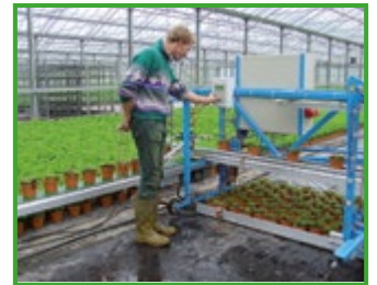
Un robot de placage permet d'éviter les nombreuses manutentions des pots
