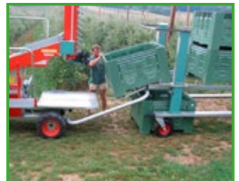
© Pluk-o-trak Munchkof Les machines de récolte des fruits réduisent les distances d'atteinte et de dépose des fruits
