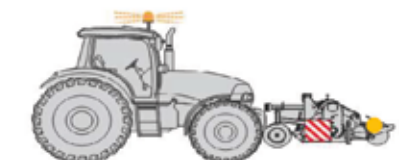
Signalisation latérale côté droit
